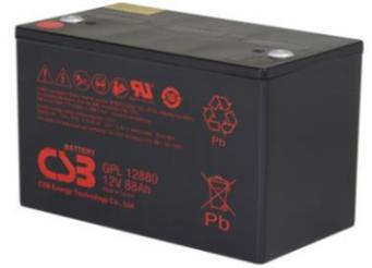
GPL 12880 - батарея общего применения со сроком службы более 10 лет в буферном режиме (Более 12 лет при 20°C по классификации Eurobat) или более 260 циклов заряда-разряда в циклическом режиме при 100% разряде. Аккумуляторы серии GPL не требуют обслуживания, долива воды, имеют низкий уровень саморазряда и высокую надежность; могут многократно перезаряжаться.
